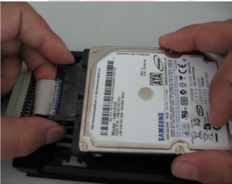
圖 5 將 SATA 軟排線與硬碟接妥,勿折到軟排線
