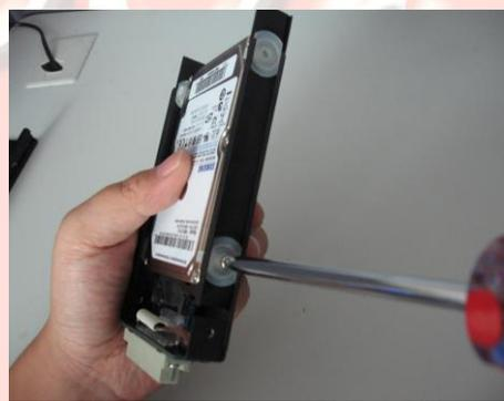
圖 6 將 4 支固定螺絲穿過防震墊圈並鎖附固定
