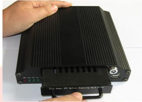
圖 2 向外拉取出硬碟盒平放到桌面上
