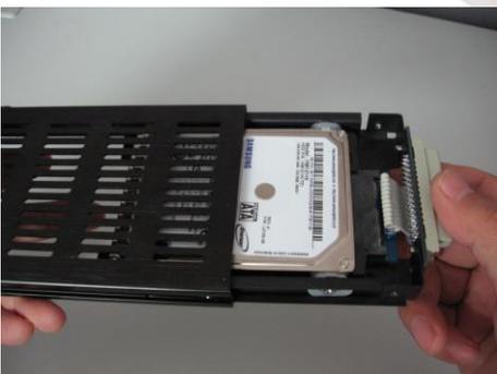
圖 7 將硬碟上下蓋結合
