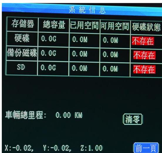
下一頁 系統資訊可查看硬碟、鏡像盤、SD 卡：總容量、已用空間、可用空間、狀態。車輛總里程顯示。如果要清零里程需要用 admin 登錄後在系統資訊裡清零。
