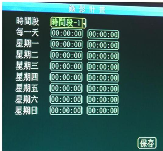
錄影常規設置裡的錄影模式如果選擇“定時錄影”模式，則需要在這裡設置定時錄影的時間段。可選擇 2 個時間段。移動游標到所需的時間段上，直接按遙控器上的數位鍵輸入。定時錄影模式一般用的比較少，客戶可以根據實際情況使用，大部分客戶還是選擇開機錄影和報警錄影。
