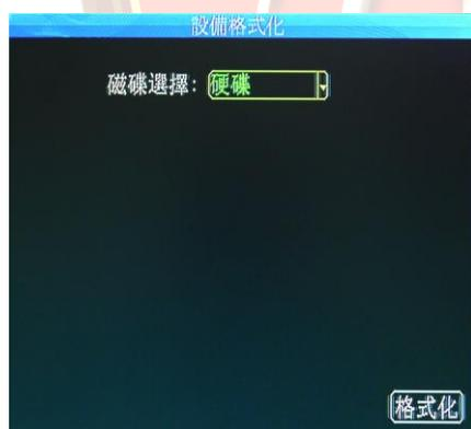
可分別選擇對硬碟、鏡像盤、SD 卡、USB 進行格式化。
